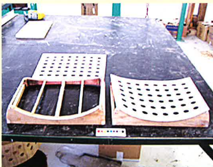
Execução dos encostos
